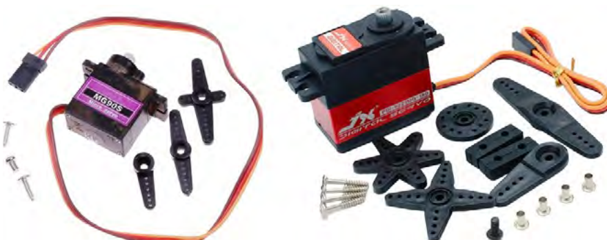
Рис. 19. Серводвигатели MG90S и PDI-6221MG-180
