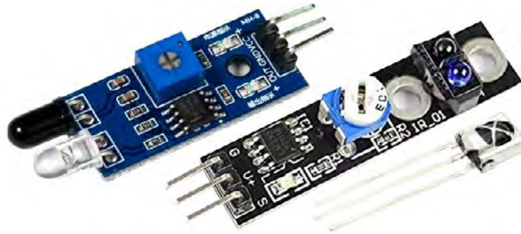
Рис. 15. Инфракрасный датчик (датчик линии)
