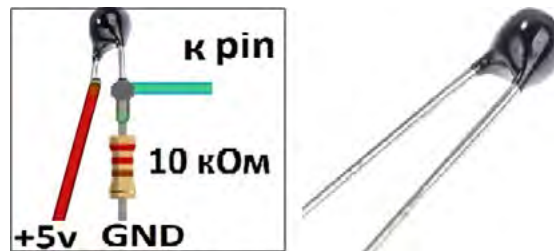
Рис. 3. Схема подключения к микроконтроллерной плате терморезистора
